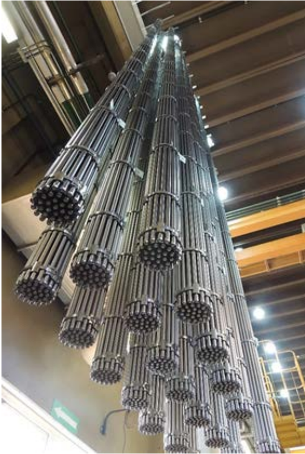
Atucha I NU and Atucha II SEU 0.85% fuel bundles 6m length - Rigid and Flex-Grids
